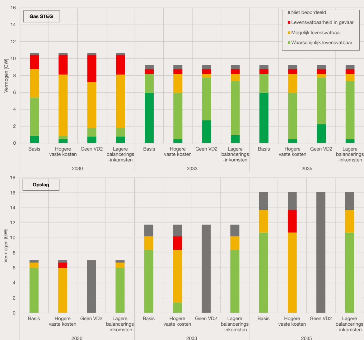
Figuur 4-13: Resultaten van de gevoeligheidsanalyses voor de economische levensvatbaarheid van de veronderstelde capaciteiten gas STEG en opslag. De categorie opslag omvat, 2-uurs batterijen, 4-uurs batterijen (wel beoordeeld), intraday LDES en multiday LDES (niet beoordeeld).
